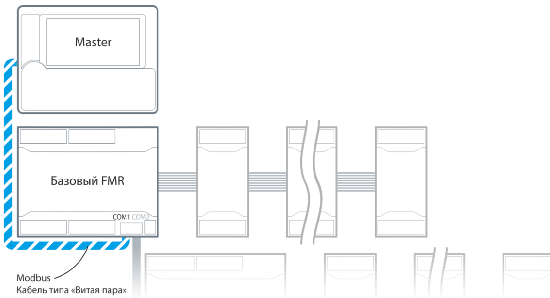
Рис. 26 - Подключение модуля FMR к контроллеру
